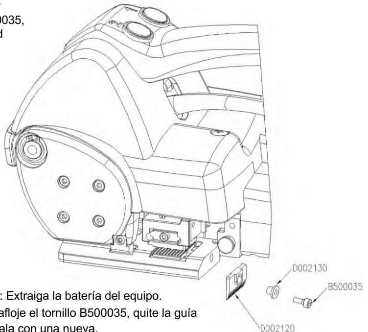
**S** — Para la sustitución de la cuchilla de corte, realice lo siguiente: Extraiga la batería del equipo. Retire el cárter de cobertura desenroscando el tornillo de fijación, afloje el tornillo B500035, quite la guía de la cuchilla D002130 y, finalmente, extraiga la cuchilla y sustitúyala con una nueva. Para volver a montar todo, realice el procedimiento inverso.
